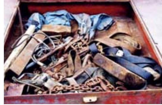
Abb. 9: Defekte Zurrmittel gefährden die Sicherheit und dürfen nicht mehr verwendet werden.
