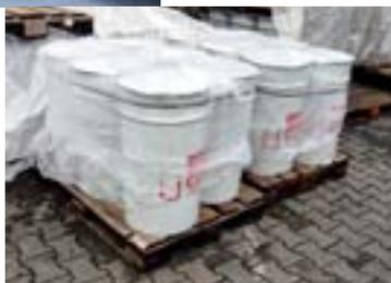
Abb. 3: Ohne eine transportgerechte Verpackung ist die ordnungsgemäße Sicherung der Ladung nicht möglich.
